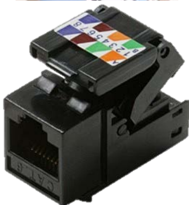
7. ábra: Hagományos fali aljzat a beszuró szerszámmal (fent) és egy önbeszurós aljzat-modul (lent)
